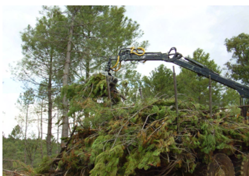
Fotografía 6: Grúa del autocargador acopiando material
