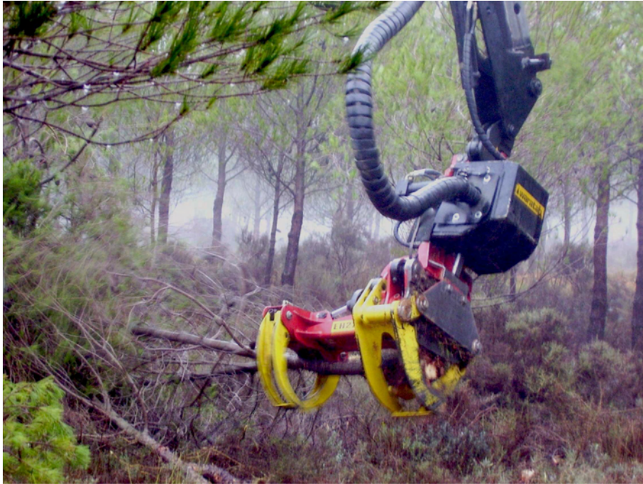
Fotografía 4: Cabezal de apeo múltiple (garras y elemento de corte)
