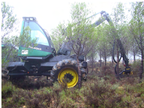
Fotografía 3: Cabezal de apeo múltiple s/ Portante Procesador
