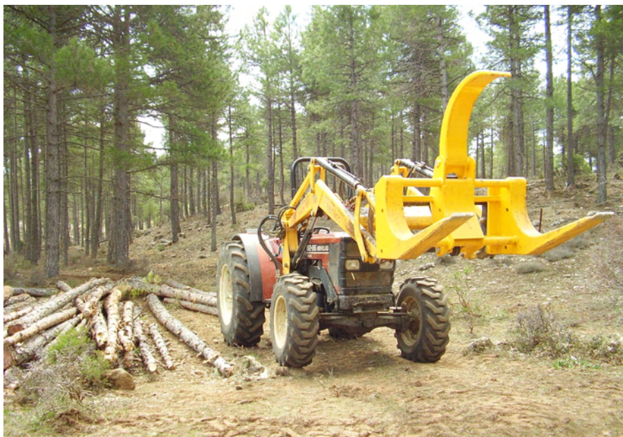
Fotografía 7: Tractor agrícola de ruedas adaptado para el agrupado de troncos
