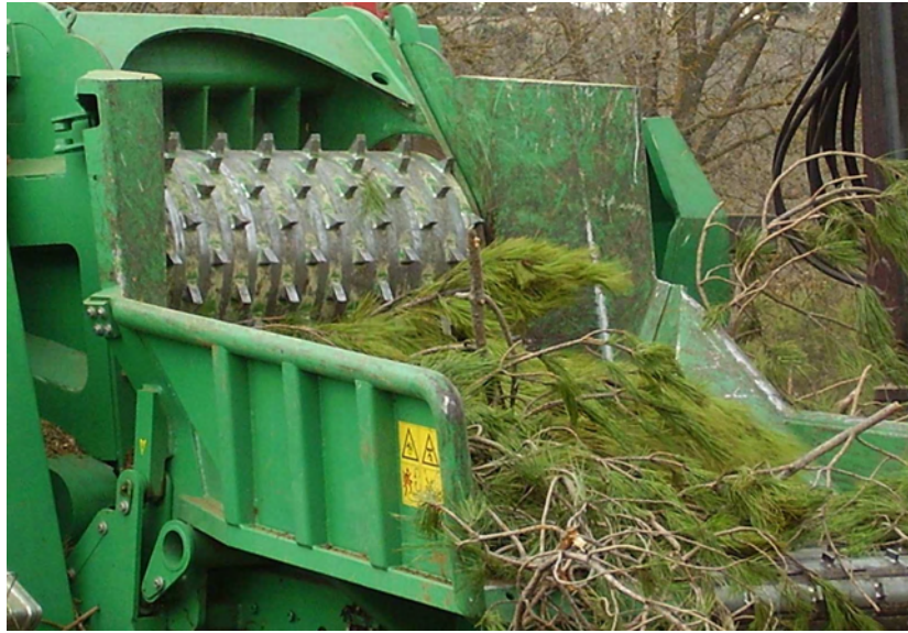
Fotografía 20: Boca de entrada de la astilladora
