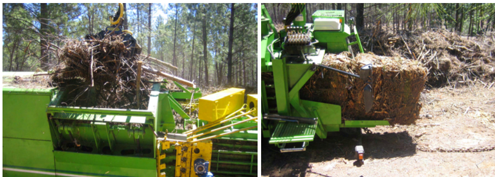
Fotografías 13 y 14: Introducción y salida del material empacado
