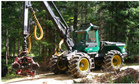
Fotografía 1: Procesadora Timberjack 870 B Fuente: http://www.impex-forstmaschinen.de/gebrauchtmachines.htm
