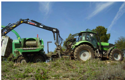
Fotografía 17: Astilladora Jenz HEM 561 Z remolcada por tractor de ruedas Deutz-Fahr con grúa
