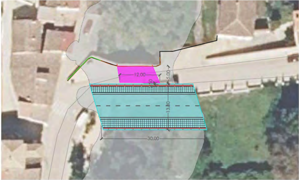
Planos de planta del puente proyectado.
