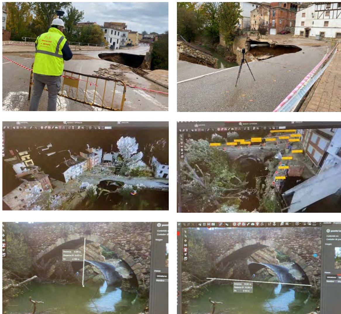
Figura 10. Trabajos de escaneo del puente y primeros resultados de su caracterización geométrica
