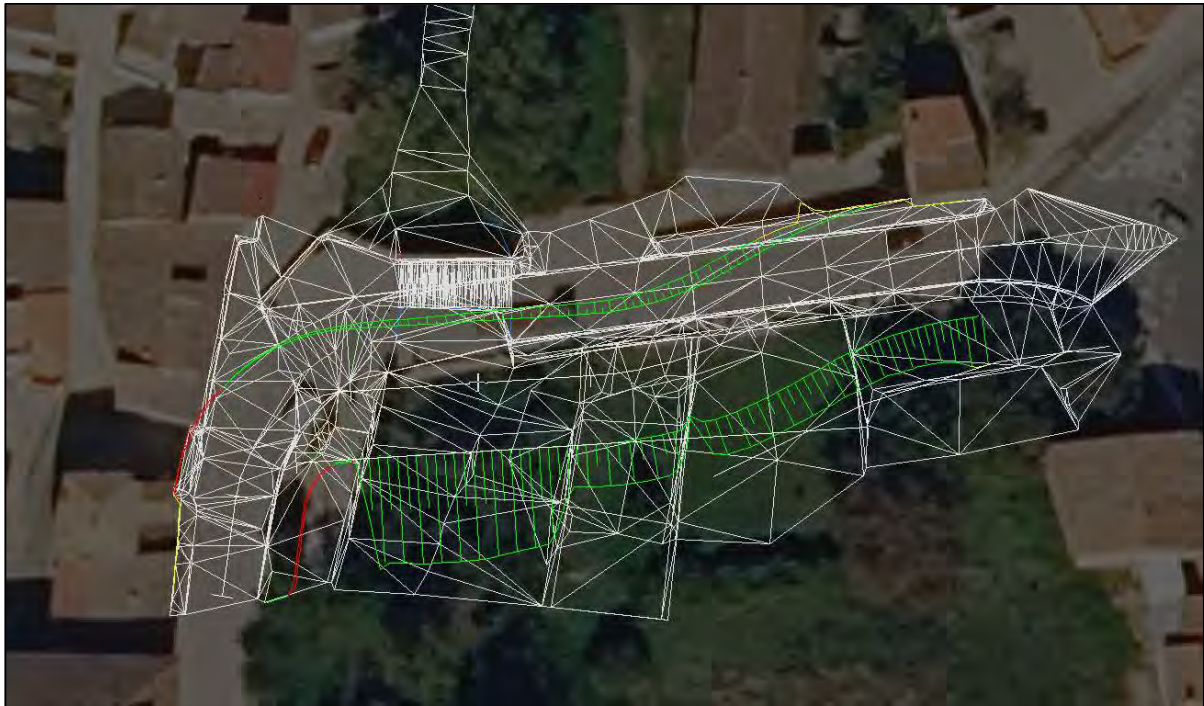
Trazado en planta con triangulación realizada con datos topográficos tomados
