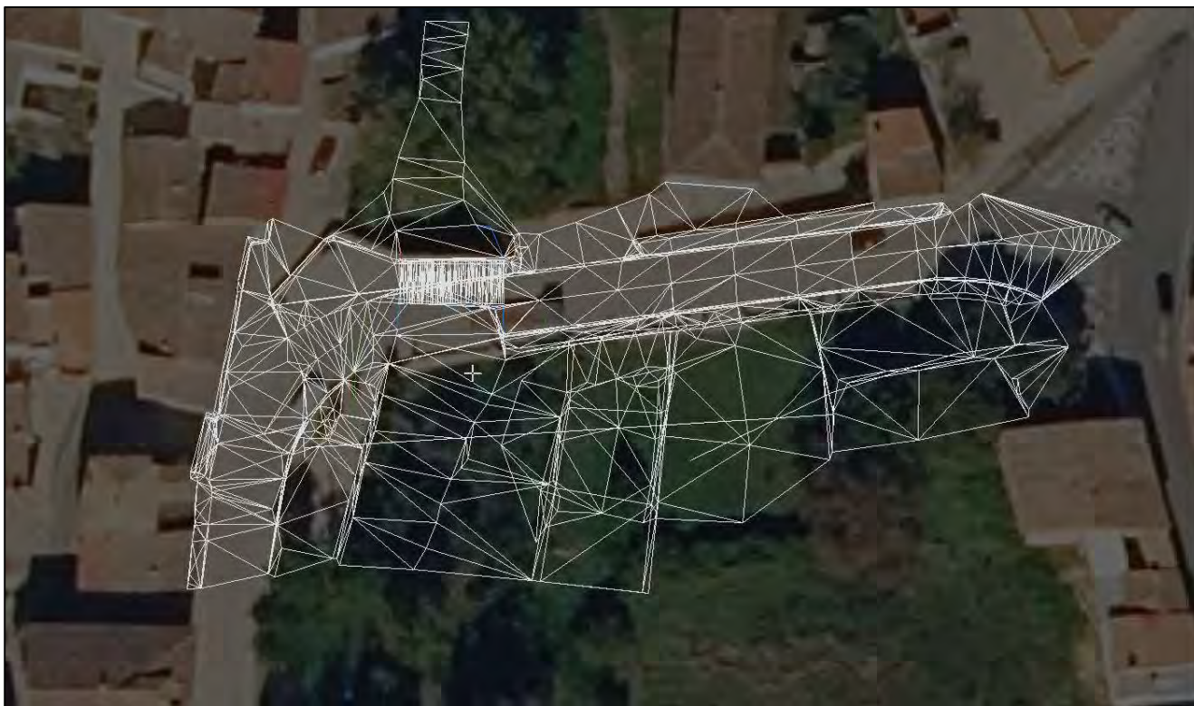
Triangulación realizada con datos topográficos tomados
