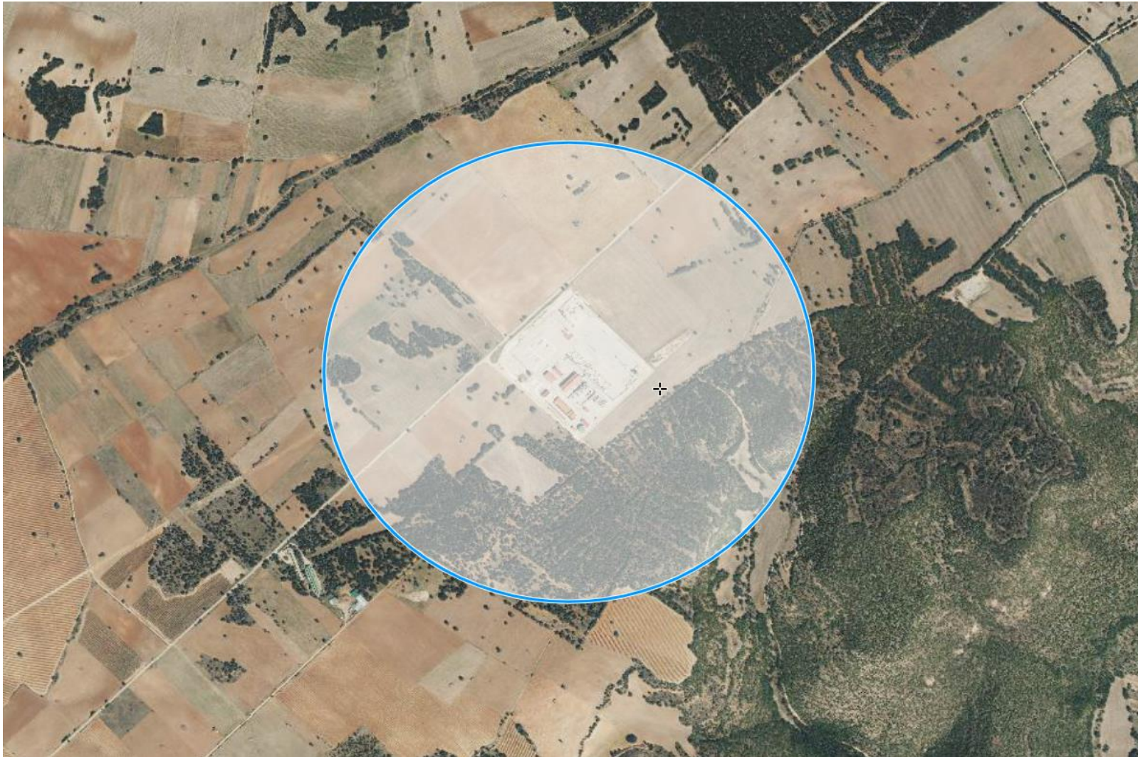
Zona de afectación (732 m) de la hipótesis accidental nº 7, la más desfavorable en las instalaciones, consistente en "Fuga de gas en el colector de baja presión tras unidades de deshidratación."
