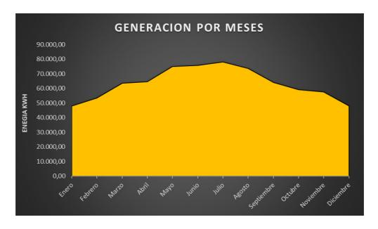
Con la implantación de la instalación fotovoltaica de 466,56 kW se evitará la emisión de 265,19 toneladas de  ${\rm CO_2}$  al año.
