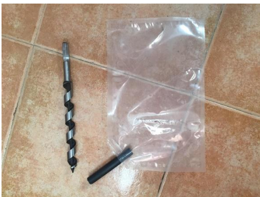
Ilustración 4. Broca y bolsas con tubo utilizadas en el ensayo del método borehole
