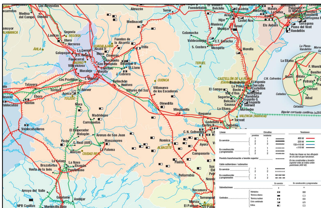
Ilustración 65: Mapa de localización de red de transporte de líneas de alta tensión (red eléctrica de España) en Castilla-la Mancha Fuente: Red Eléctrica de España. Sistema eléctrico Peninsular. Instalaciones en servicio a 31 de Diciembre de 2017 y en construcción o programadas.
