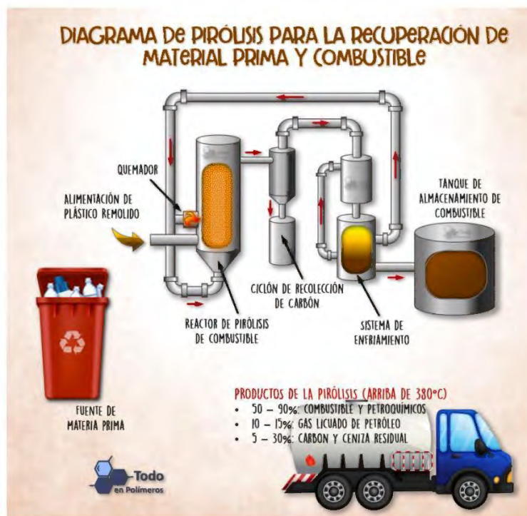
Figura 2: Ejemplo de un esquema básico de proceso de pirólisis de residuos plásticos.
